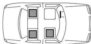
1) Применение разрешается только на установленном против движения автомобильном сиденье (напр., в жилом фургоне, микроавтобусе), которое также допускается для транспортировки взрослого человека. Сиденье не должно быть оборудовано надувной подушкой безопасности.
