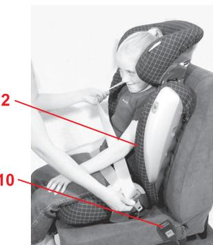
☞ Усадите ребенка в детское сиденье. ☞ Вытяните автомобильный ремень и уложите его перед ребенком к замку автомобильного ремня **10**. **Внимание!** Не допускать скручивания ремня. ☞ Зафиксируйте язычки в замке автомобильного ремня **10**. ЩЕЛК!
