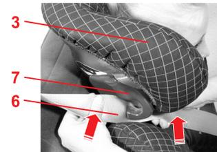
☞ Pase el cinturón diagonal **6** por el soporte de color rojo oscuro **7** del reposacabezas **3**, hasta que se deslice por detrás de la lengüeta de bloqueo **7**. **Un consejo:** Si cubre el respaldo **2** con el soporte del cinturón **7**, los reposacabezas **3** se podrán levantar. Ahora se puede introducir con facilidad el cinturón diagonal **6**. Vuelva a colocar ahora el reposacabezas **3** a la altura adecuada.
