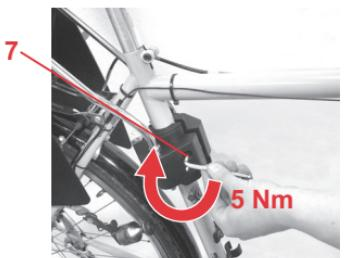
☞ Dokręcić śruby 7 mocowania 5 kluczem imbusowym (rozmiar 5) z momentem dokręcenia 5 Nm.
