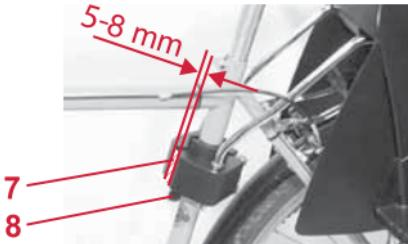
❖ Затяните винты **7** крепления **5** с помощью торцового шестигранного ключа (размер 5) с моментом затяжки 5 Нм. Используйте контрольный образец **X** для проверки правильности крепления. С помощью контрольного образца **X** убедитесь, что зазор на винтовом соединении **7** составляет не более 8 мм (толстая сторона контрольного образца) и не менее 5 мм (тонкая сторона контрольного образца).
