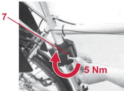
► Dokręcić śruby **7** mocowania **5** kluczem imbusowym (rozmiar 5) z momentem dokręcenia wynoszącym 5 Nm. Użyć elementu kontrolnego **X** w celu sprawdzenia poprawności mocowania.
