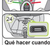
Aparte la funda del asiento y el cojín de espuma de la superficie del asiento y cambie las dos pilas de tipo AAA del compartimento de las pilas (24).
