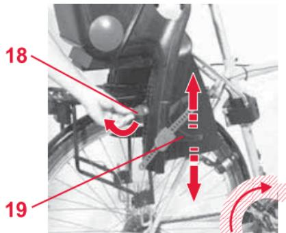
Potete adattare l'altezza delle cinture spalle alle dimensioni del vostro bambino come riportato di seguito:
