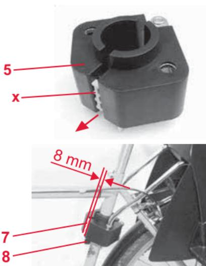
☞ Dra sedan åt skruvarna 7 på hållaren 5 med en insexnyckel (storlek 5) till åtdragningsmoment 5 Nm.
