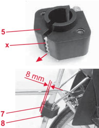
☞ Stringete adesso le viti **7** del supporto **5** con una chiave per viti ad esagono cavo (misura 5) con una coppia di serraggio di 5 Nm.
