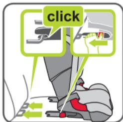
8. Schieben Sie beide ISOFIT-Rastarme 05 in die Einführhilfen 02 bis die ISOFIT-Rastarme 05 auf **beiden Seiten** mit einem „Klick“Geräusch einrasten.
