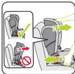
10. Rütteln Sie am Auto-Kindersitz, um sicherzustellen, dass er sicher befestigt ist und kontrollieren Sie erneut die Sicherungsknöpfe 07, um sicherzustellen, dass **beide** vollständig grün sind.
