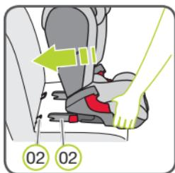
6. Stellen Sie den Kindersitz in Fahrtrichtung auf einen für die Verwendung zugelassenen Autositz. Achten Sie darauf, dass die Rückenlehne 10 flächig an der Rückenlehne des Fahrzeugsitzes anliegt.
