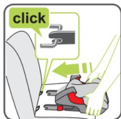
6. Schieben Sie beide ISOFIT-Rastarme 05 in die Einführhilfen 02 bis die ISOFIT-Rastarme 05 auf beiden Seiten mit einem „Klick“Geräusch einrasten.
