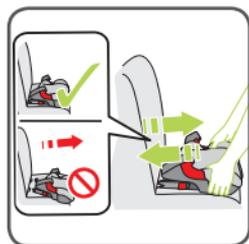
8. Rütteln Sie am Auto-Kindersitz, um sicherzustellen, dass er sicher befestigt ist und kontrollieren Sie erneut die Sicherungsknöpfe 07, um sicherzustellen, dass **beide** vollständig grün sind.
