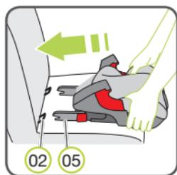
4. Stellen Sie den Kindersitz in Fahrtrichtung auf einen für die Verwendung zugelassenen Autositz. Achten Sie darauf, dass die Rückenlehne 10 flächig an der Rückenlehne des Fahrzeugsitzes anliegt.
