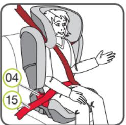
7. Führen Sie den Diagonalgurt 16 in den dunkelroten Gurthalter 03 der Kopfstütze 22 ein, bis er vollständig und unverdreht im Gurthalter 03 liegt.
