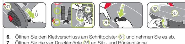
6. Öffnen Sie den Klettverschluss am Schrittpolster (31) und nehmen Sie es ab.
