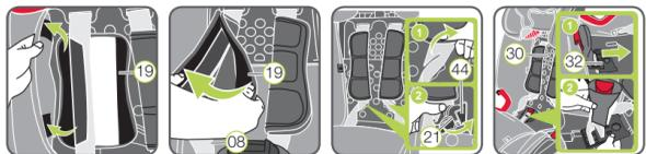
5. Lösen Sie die beiden Druckknöpfe am Rückenteil des Bezuges.
