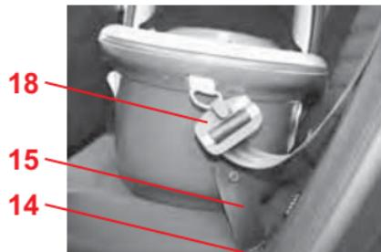
☞ Sprzączkę pasa bezpieczeństwa **18** środkowego siedzenia tylnego zaczepiamy przy końcu na głowkę **20** gondoli za pierścienie w kształcie litery D **12**.
