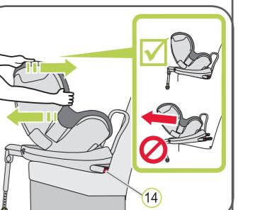
8. Zatraste detskú autosedačku, aby ste sa uistili, že je bezpečne pripojená a znova skontrolujte indikátory ISOFIX 14, aby ste mali istotu, že sú oba úplne zelené.
