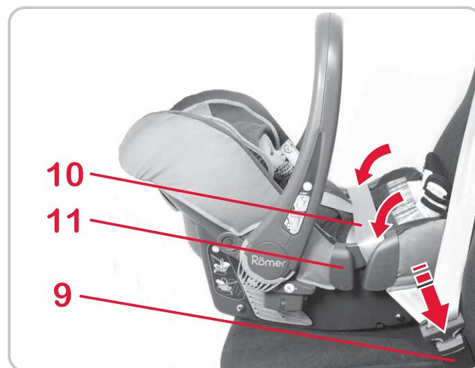
☞ Stellen Sie die Babyschale entgegen der Fahrtrichtung (Baby schaut nach hinten) auf den Fahrzeugsitz.
